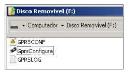
• Rode o software de configuração "GprsConfigura" de dentro do pendrive.
